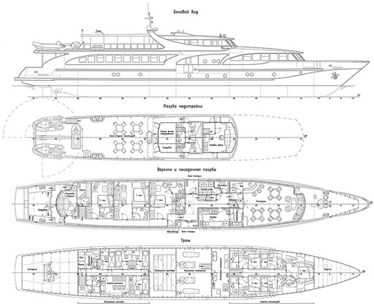
Проект речной круизной яхты представительского класса на базе модернизированного корпуса теплохода ОМ с новой надстройкой.
