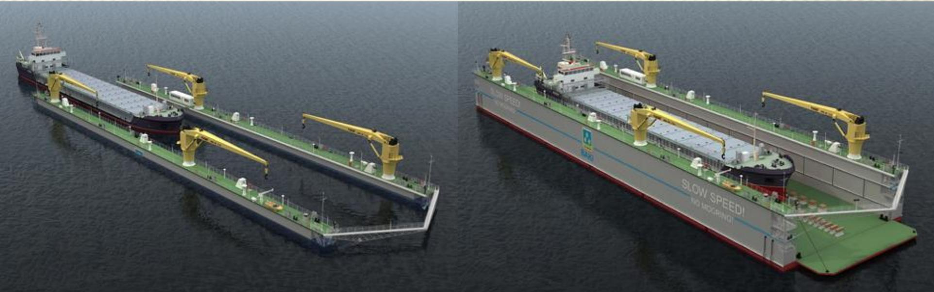
**Док проекта 28140** - плавучий, ремонтный, несамоходный, самодокующийся, автономный док. Предназначен для докования судов массой до 8000 т. Проект разработан фирмой "Си Тех". В настоящее время док строится на Городецкой ССК и будет эксплуатироваться в акватории судоремонтного завода г. Баку
