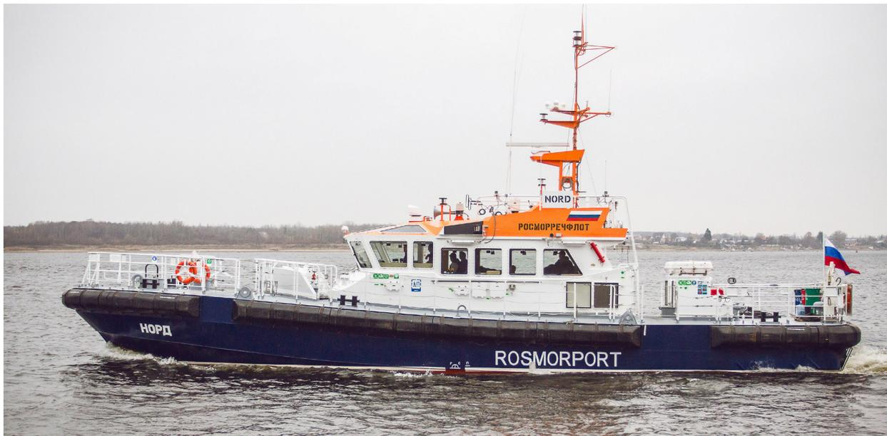
Скоростной катер ледового класса пр. ST23WI предназначен для использования в служебно-разъездных целях, для доставки на борт судов комиссий, членов экипажей судов и их семей, перевозки грузов весом до 0.5 т, для патрулирования, осмотра и экологического мониторинга акваторий, а также имеет возможность выполнения функций лоцманского катера.
