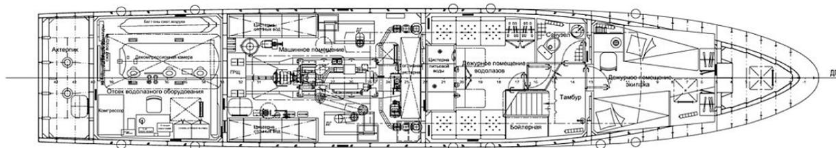
Проект водолазного судна РВ1415М – новая версия популярного катера "Фламинго" – простой, дешевый и надежный катер для водолазных работ на глубине до 45 м. От своего предшественника (пр. РВ1415) отличается улучшенной обитаемостью и конструктивно-техническим обеспечением соблюдения современных норм безопасности при выполнении водолазных работ.
