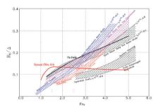
Коротко можно сказать, судовладелец либо получает осязаемую выгоду в прибавке скорости (до 40%) при той же мощности, либо снижает (до 30%) расход топлива при той же скорости. Эффект достигается за счет того, что гидродинамическое качество подводного крыла всегда выше любой самой «умной» глиссирующей поверхности.
