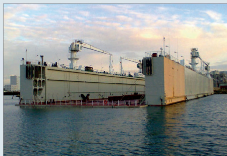
Плавучий металлический ремонтный док. Грузоподъемность 8000 тонн, проект 28 140 (000 «Си Тех»).
